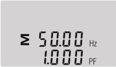
Hier wird die momentane Frequenz [Hz] und Leistungsfaktor [PF] angezeigt.
