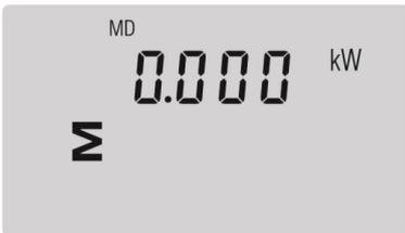
Hier wird die gespeicherte maximale Leistung [kW] aller drei Phasen angezeigt
