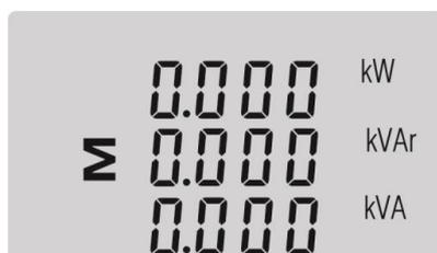
Hier werden die Gesamtwerte der Wirkleistung [kW], der Blindleistung [kVAr] und die Scheinleistung [kVA] angezeigt.
