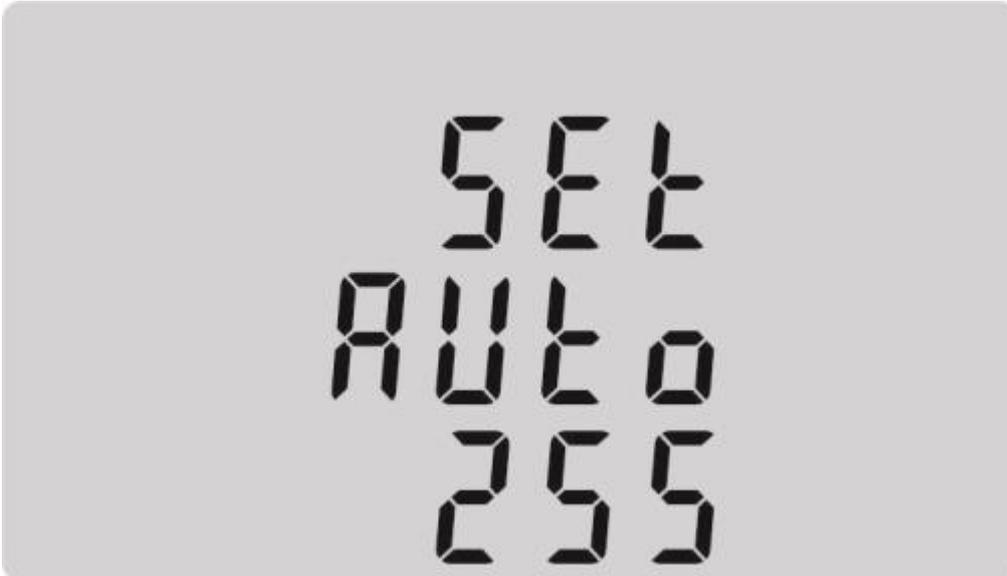
Um das Scroll Menu zu aktivieren wählen Sie den gewünschten anzuzeigenden Menü Punkt mit den Tasten „VA“, „P/PF“ oder „E“ und drücken die Taste „V/A“ lang bis der Display Punkt
