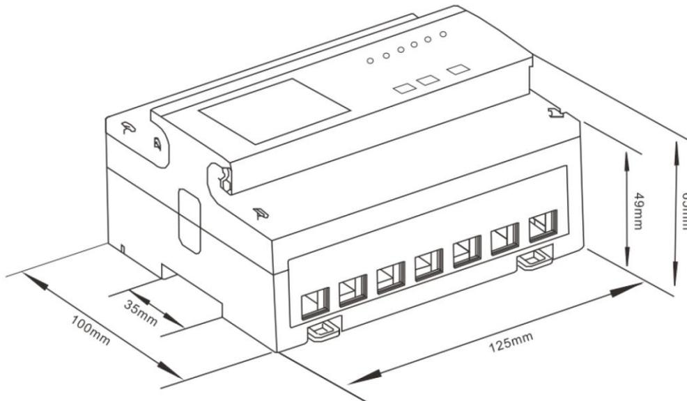
Die Gerätebefestigung erfolgt an einer 35 mm Tragschiene nach EN 50022.
