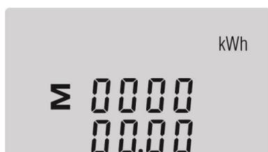
Hier wird die Wirkleistung [kWh] aus Import + Export angezeigt.
