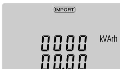
Hier wird die aufgenommene Blindleistung [kVAh] angezeigt.
