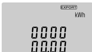
Hier wird die abgegebene Wirkleistung [kWh] angezeigt.
