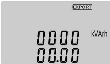
Hier wird die abgegebene Blindleistung [kVArh] angezeigt.
