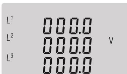
Hier werden die aktuellen Spannungen [V] zwischen den Phasen und dem Neutralleiter (3p4w) angezeigt.
